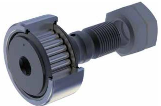
Este es el seguidor de leva con espárrago clásico de Nadella actualizado con la ampliación del casquillo hexagonal de ajuste en cada extremo y para todas las dimensiones. También se ha introducido el perfil optimizado en el diámetro exterior del anillo (véase la pág. 59 para más detalles)
